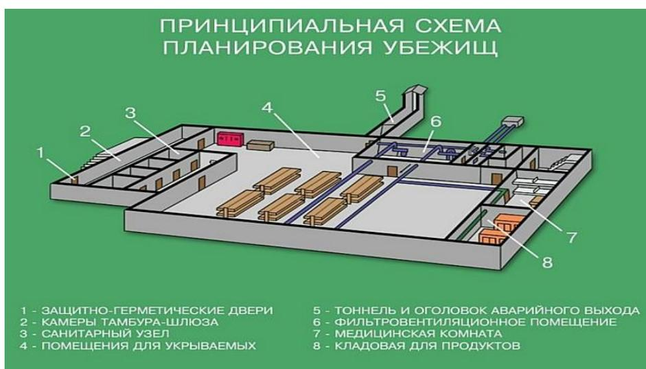
**Убежища** - это специальные сооружения, предназначенные для защиты укрывающихся в них людей от всех поражающих факторов ядерного взрыва, отравляющих веществ, бактериальных средств, а также от высоких температур и вредных газов, образующихся при пожарах. Убежища для личного состава войсковых подразделений называются общевойсковыми. При стационарном размещении войск оборудуются стационарные убежища, при полевом – полевые убежища.
