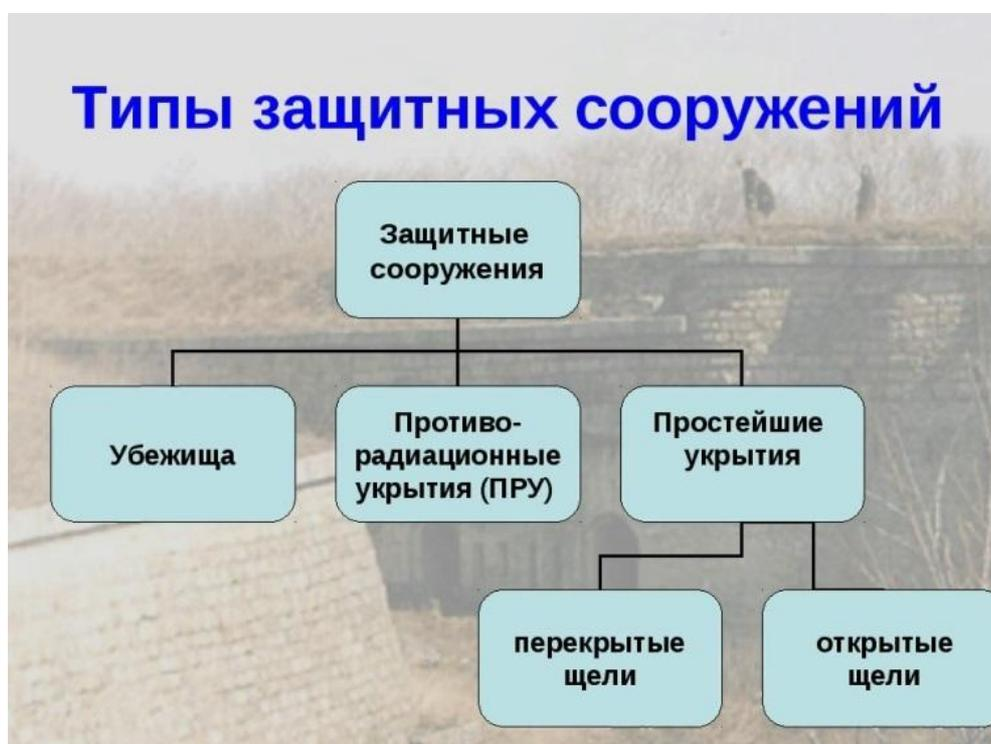
Схема 3. Типы защитных сооружений, предназначенных для защиты людей и материальных средств от воздействия поражающих факторов ядерного взрыва, химически токсичных веществ, биологически опасных средств, продуктов горения, высоких температур.
