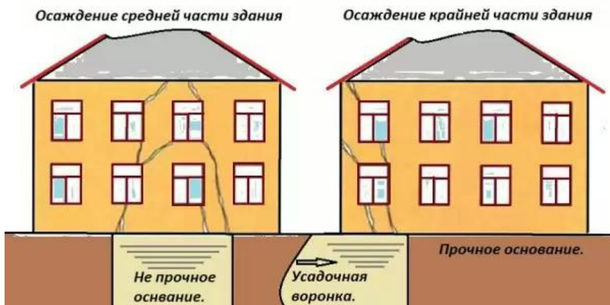
Влияние просадки фундамента на конструкции строения
